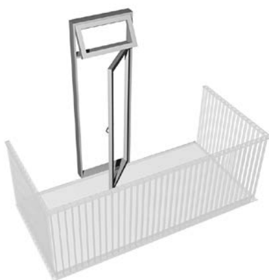
Enkeldörr i helglas med ett öppningsbart överljus.
