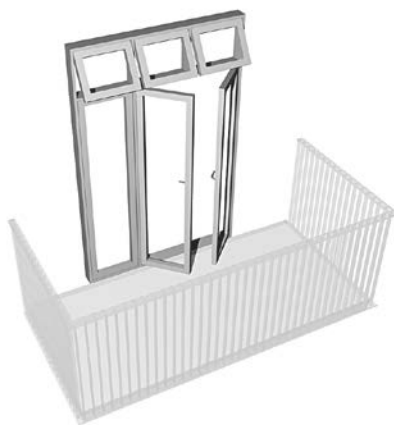
Pardörr med fast sidoljus i helglas med tre öppningsbara överljus.
